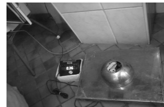
Figura 14 - Pesagem do recipiente com 2 L de amostra para determinação do teor de umidade.
