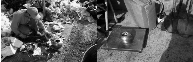
Figura 9 - Amostra de 2L de resíduos sendo selecionada e posteriormente pesada.
