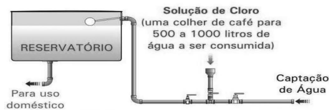
Figura 7 - Instalação de Clorador Embrapa na Rede de Captação de Água.
