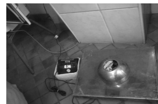
Figura 14 - Pesagem do recipiente com 2 L de amostra para determinação do teor de umidade.
