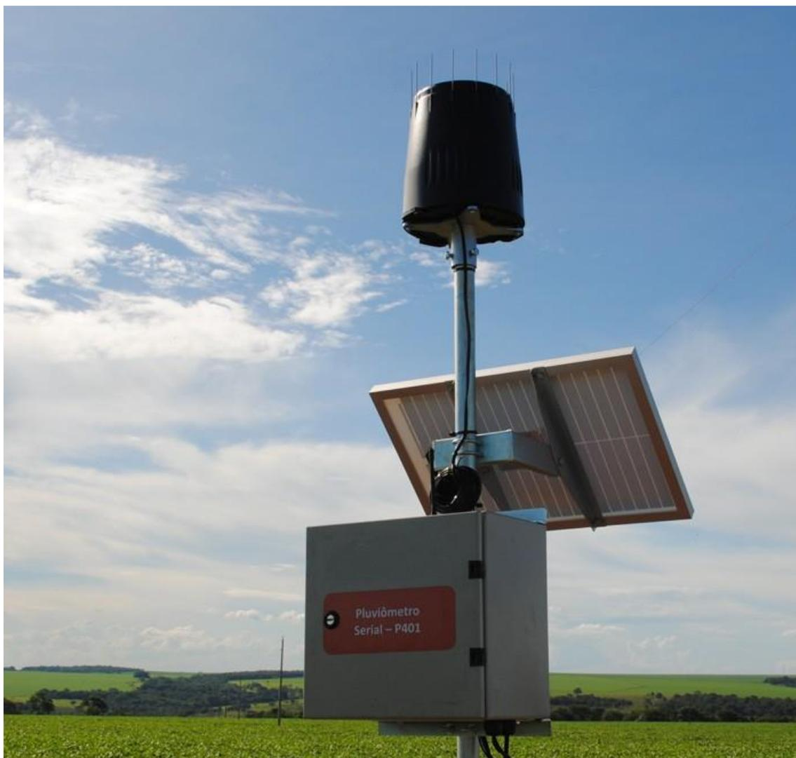
**Imagem 5** – Pluviômetro Automático
