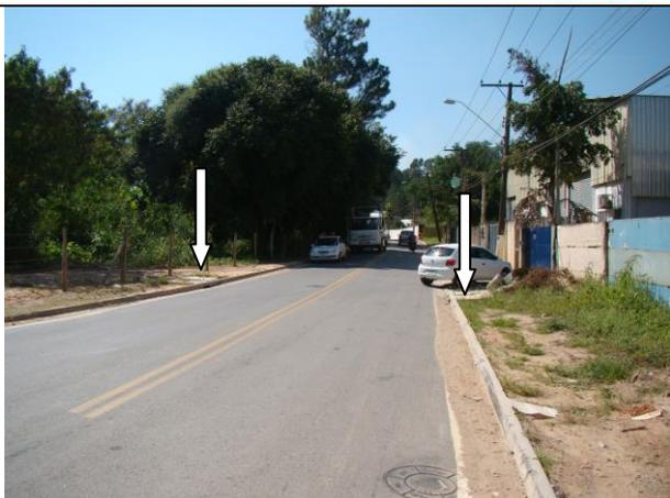
**FOTO 39.** Vista geral da rua Atílio Biscuola, em direção à travessia sobre o rio Capivari. As setas indicam bocas de lobo por onde podem ocorrer refluxos de água.
